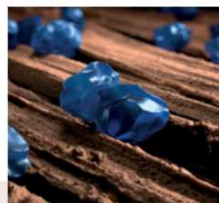
2. ábra A Partix technológiás, nagy szemcsékhez rögzített hatóanyagok a felszínen maradnak porózus felületeken is (500-szoros nagyítás)
